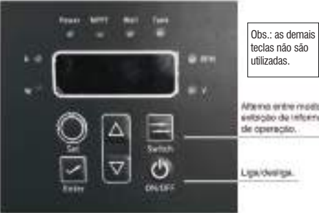
Figura – Painel de operação do controlador
