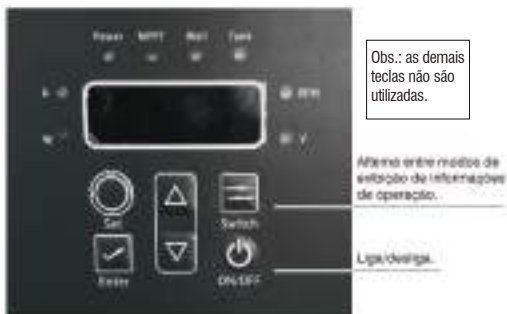
Figura – Painel de operação do controlador
