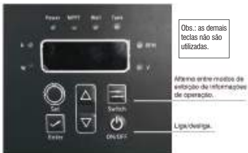
Figura – Painel de operação do controlador
