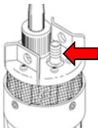
Posicione a abraçadeira de forma a fixar a mangueira na conexão da bomba e aperte a abraçadeira para finalizar a montagem.
