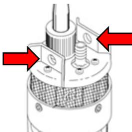
Puxe a ponta do cabo passado pelos orifícios e prenda-a ao cabo, em entre 30 e 60cm acima da bomba, utilizando-se do grampo para cabo de aço:
