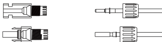
Figura 5.13: Conectores CC com os Cabos Crimpados
