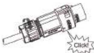
Figura 5.18: Aperto da Porca do Cabo para Comprimir o Inserto de Borracha
