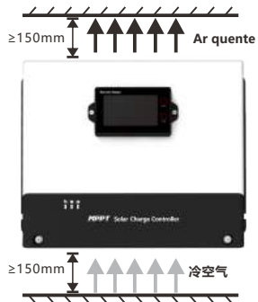
Fig. 2.1 Instalação e Dissipação de calor
