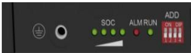
O aterramento do módulo é baseado no contato direto entre a superfície do módulo e a superfície do rack. Portanto, não é necessário utilizar cabos de aterramento. Se for usado um rack comum, pode-se remover a pintura no local correspondente ou instalar um cabo de aterramento no ponto de aterramento dos módulos.
