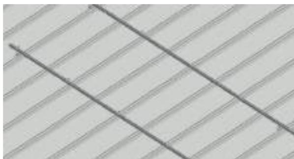
**5** Em seguida faça o aperto das porcas pela parte inferior, utilizando uma chave de boca 13mm, mantendo o alinhamento do trilho. Repita esta operação para todos os suportes. Certifique-se de que todos os parafusos estejam devidamente fixados.
