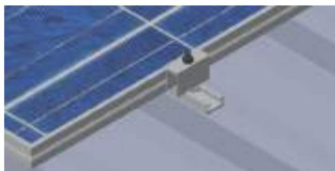
**7** Os clamps possuem sistema que facilita o aterramento dos módulos. Realize o teste de passagem de corrente entre os furos, o módulo e a estrutura utilizando um multímetro, para se certificar do perfeito aterramento. Caso haja necessidade, utilizar furos de aterramento do próprio módulo.
