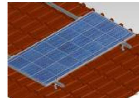
**9** Posicione os dois clamps intermediários e em seguida o módulo seguinte, faça o alinhamento e fixe-os. Faça este processo para os demais módulos, sempre certificando-se do correto posicionamento e fixação dos clamps.
