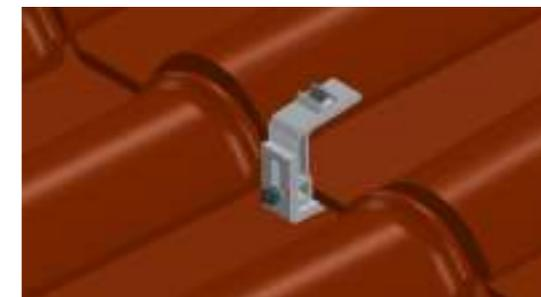
**5** Após fixado o gancho no caibro, ajuste e fixe a peça que sai da base, através da porca ali localizada, de modo que o suporte não encoste na telha que está por baixo e que fique centrado a calha. Certifique-se se o gancho está bem fixado apertando os parafusos.
